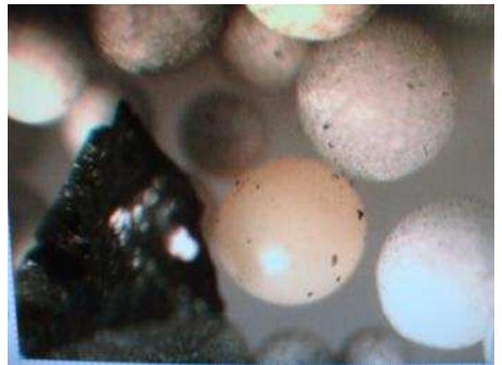
Le contenu d'une cartouche Brita vue au microscope
